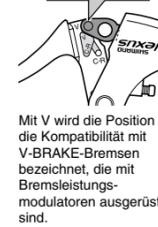
Mit V wird die Position für die Kompatibilität mit V-BRAKE-Bremsen bezeichnet, die mit Bremsleistungsmodulatoren ausgerüstet sind.
