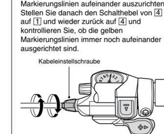
2. Schneiden Sie nach dem Einstellen der Schalteinheit das vorstehende Kabel ab und bringen Sie eine Kabelkappe an.
