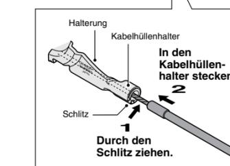
Falls es einfacher ist, zuerst die Kabelhülle in den Kabelhüllenhalter einsetzen, einen 2 mm-Inbusschlüssel oder eine Speiche #14 in das Schaltradloch stecken und das Schaltrad drehen, um die Kabelbefestigungsschraube richtig in die offene Seite des Schaltrades zu passen.
