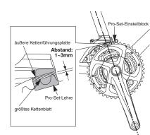
Stellen Sie die Höhe des Umwerfers ein. Der flache Teil der äußeren Kettenführungsplatte muss sich von oben gesehen parallel zum arößten Kettenblatt befinden. Mit einem 5mm-Inbusschlüssel festziehen
