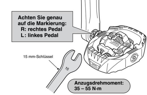
**Hinweis:** Mit einem 6 mm-Inbusschlüssel kann nur ein ungenügendes Anzugsdrehmoment erreicht werden. Verwenden Sie aus diesem Grund immer einen 15 mm-Schlüssel.
