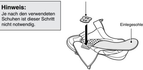
3. Legen Sie eine Schuhplatte und einen Schuhplattenadapter dessen Bohrungen auf die Schuhplatte ausgerichtet sind auf die Schuhsohle. Die Schuhplatten für das linke und das rechte Pedal sind identisch. Setzen Sie dann die Befestigungsschrauben ein, und ziehen Sie sie provisorisch fest.
