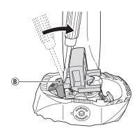
4. Stellen Sie mit der Einstellschraube des Pedals die stärkste Federspannung ein.
