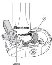
3. Heben Sie die Lasche an der anderen Reflektorseite mit einem Schraubenzieher an, um sie an der Stelle ® einzuhaken.
