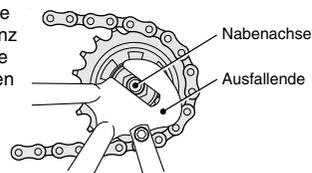
2. Setzen Sie die Sicherungsscheibe auf der linken Seite der Nabenachse an. Drehen Sie die Nabenachse, so daß der Vorstand der Sicherungsscheibe in den Schlitz des Ausfallendes eingreift.
