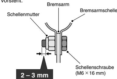
5. Kontrollieren Sie vor dem Verwenden der Rücktrittbremse, ob die Bremse richtig funktioniert und sich das Rad leicht drehen lässt.
