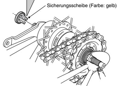
3. Bringen Sie die Flanschnuttern auf die beiden Seiten der Nabenachse an. Straffen Sie die Kette und ziehen Sie die Flanschnuttern richtig fest, um das Rad am Rahmen zu befestigen.
