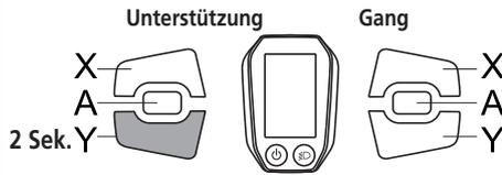
Wenn die Geschwindigkeitsanzeige „0“ anzeigt, können Sie durch Drücken der Taste Unterstützung-Y für 2 Sekunden in den Schiebe-Unterstützungsmodus umschalten.
