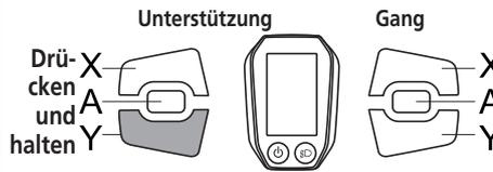
Wenn [GEHEN] angezeigt wird, halten Sie Unterstützung-Y am Unterstützungsschalter gedrückt, um die Schiebe-Unterstützungsfunktion zu starten. Unterstützung-Y beendet die Schiebe-Unterstützungsfunktion, oder Sie können mit Unterstützung-X die Schiebe-Unterstützungsfunktion beenden.
