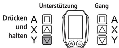
Wenn [GEHE] angezeigt wird, halten Sie Unterstützung-Y auf dem Unterstützungsschalter gedrückt, um die Schiebe-Unterstützungsfunktion zu starten. Die Schiebe-Unterstützungsfunktion wird mit Unterstützung-Y oder durch Drücken der Taste Unterstützung-X beendet.
