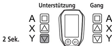
Wenn die Geschwindigkeitsanzeige „0“ anzeigt, können Sie in den Schiebe-Unterstützungsmodus schalten, indem Sie die Taste Unterstützung-Y 2 Sekunden lang drücken.
