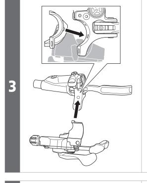
Führen Sie die Nase der Schalthebelhalterung in die Öffnung der Bremsgriffhalterung ein.
