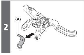
Entfernen Sie den innen an der Befestigungsschelle angebrachten Adapter. Entfernen Sie eventuell noch vorhandene Klebstoffreste. (A) Adapter
