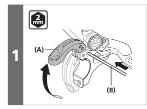
Öffnen Sie die Befestigungsschelle des Bremsgriffs wie abgebildet mit einem Innensechskantschlüssel.
