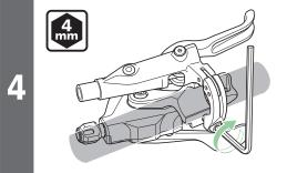
Ziehen Sie die Befestigungsschelle des Bremsgriffs mit einem Innensechskantschlüssel fest. Anzugsdrehmoment
