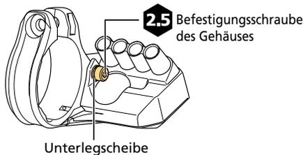
Fahrradcomputer (Typ mit integrierter Schaltereinheit)
