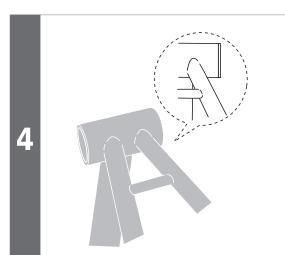
Vergewissern Sie sich, dass zwischen dem Innenlager und der Innenlagerschale kein Spalt vorhanden ist.
