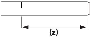
Markieren Sie die betreffende Stelle der Bremsleitung wie in der Abbildung gezeigt. So können Sie überprüfen, ob die Enden der Bremsleitung sicher mit den Leitungsanschlüssen von Bremssattel und Dual-Control-Schalt-/Bremshebel verbunden sind.
