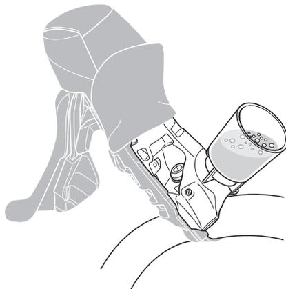
Sobald sich keine Luftblasen mehr in dem Öl im Öltrichter befinden, ziehen Sie die Entlüftungsschraube zunächst fest.
