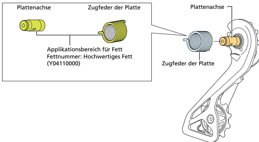
2. Setzen Sie das Ende der Zugfeder der Platte in die Bohrung in der Platte ein, und führen Sie die Plattenachse in das Schaltwerk ein.
