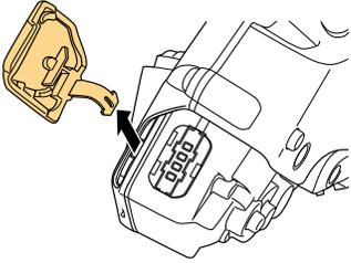
2. Ersetzen Sie sie durch eine neue Ladeanschlussabdeckung.
