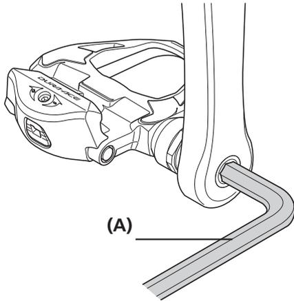
Verwenden Sie einen 8 mm-Innensechskant- oder einen 15 mm-Schraubenschlüssel, um die Pedale am Kurbelarm zu montieren.
