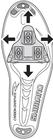
Der Cleat lässt sich 11 mm von vorn nach hinten verschieben und 5 mm von rechts nach links.
