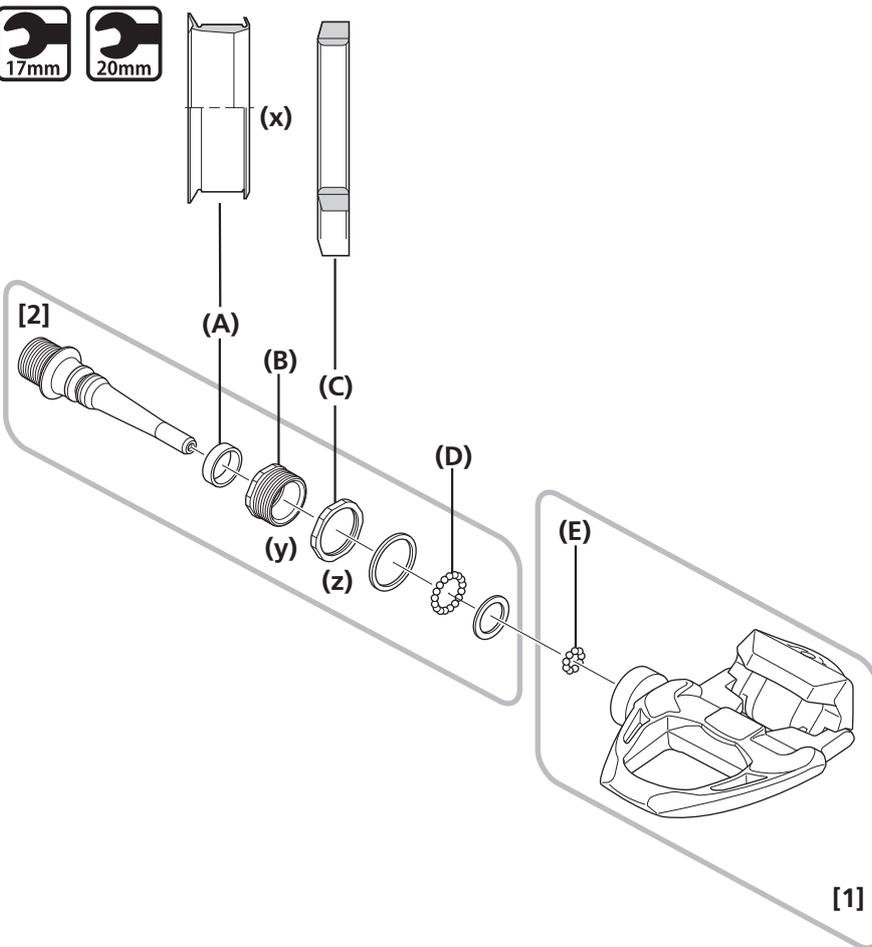
(x) Achten Sie beim Einbau der Gummidichtung und der Kontermutter auf die richtige Ausrichtung der Teile.
