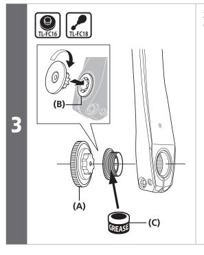
Ziehen Sie mit Hilfe des SHIMANO-Originalwerkzeugs die Kappe an.
