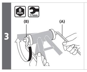
Pressen Sie das Innenlager ein, indem Sie es mit einem Schraubenschlüssel anziehen. Achten Sie dabei darauf, dass der Rand des Innenlagers parallel zur Kontaktfläche der Tretlagerschale bleibt.
