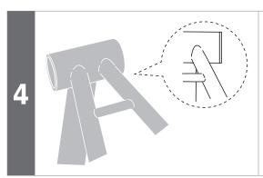
Vergewissern Sie sich, dass zwischen dem Innenlager und der Tretlagerschale kein Spalt vorhanden ist.
