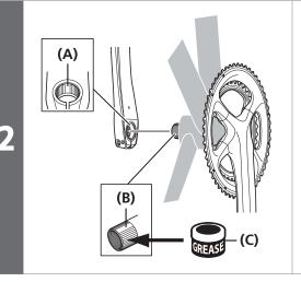
Positionieren Sie den Bereich der linken Kurbel, der eine breite Nut aufweist, auf der breiten Nut der Achse der rechten Kurbeleinheit.
