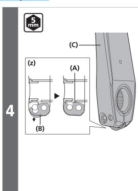
Drücken Sie die Anschlagplatte hinein und vergewissern Sie sich, dass sich der Plattenstift ordnungsgemäß an seinem Platz befindet. Ziehen Sie dann die Schrauben des linken Kurbelarms an.
