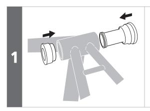
Setzen Sie das Innenlager in die Tretlagerschale ein.
