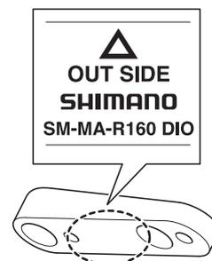
► Montieren des Bremssattels
