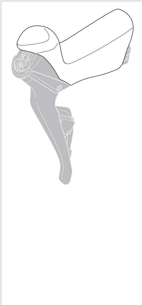
Passen Sie die Nasen an der Halterungsabdeckung jeweils in einen entsprechenden Schlitz in der Halterung ein.
