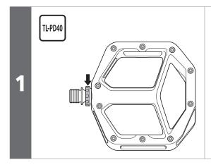
Verwenden Sie das original SHIMANO-Werkzeug TL-PD40, um die Steckbuchse zu lösen und die Achseinheit herauszuziehen.
