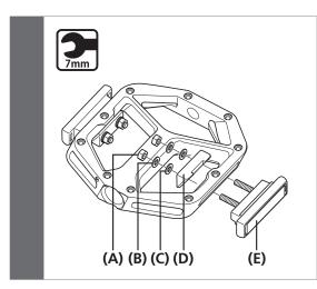
Es ist ein Spezialreflektorsatz SM-PD67 erhältlich. Montieren Sie die Reflektoren mit den Befestigungsmuttern und der Reflektorbefestigungsplatte.
