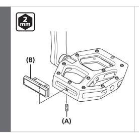
Es ist ein Spezialreflektorsatz SM-PD64A erhältlich. Montieren Sie die Reflektoren mit den Befestigungsschrauben für Reflektoren.
