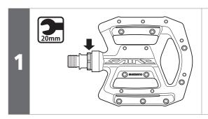
Verwenden Sie einen 20-mm-Schraubenschlüssel, um die Steckbuchse zu lösen und die Achseinheit herauszuziehen.
