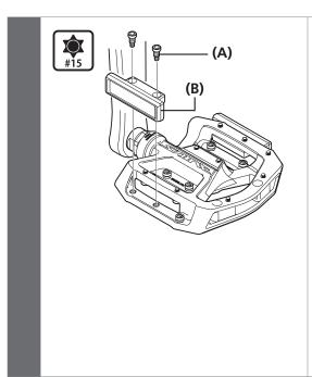
Es ist ein Spezialreflektorsatz SM-PD64 erhältlich. Montieren Sie die Reflektoren mit Stiften.
