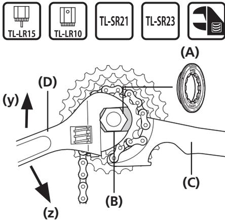
Bei der Montage der HG-Zahnkränze muss zum Festziehen des Sicherungsringes das Originalwerkzeug TL-LR15/LR10 von Shimano verwendet werden. Beim Austausch eines HG-Zahnkränzes müssen zum Entfernen des Sicherungsringes die Originalwerkzeuge TL-LR15/LR10 und TL-SR21/23 von Shimano verwendet werden.
