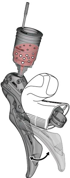
**25. Betätigen Sie den Bremshebel mehrmals und vergewissern Sie sich, dass die Bremsbeläge die Bremsscheibe greifen und dass sich am Hebel Bremsdruck aufbaut.**
