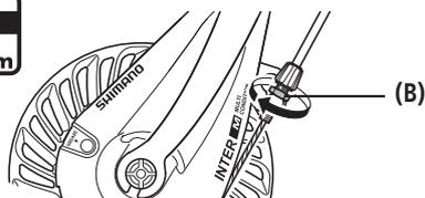
Nachdem Sie den Bremsgriff gezogen haben, um die Bremsleistung zu prüfen, sichern Sie die Zugeinstellschraube mit der Zugeinstellmutter (B).
