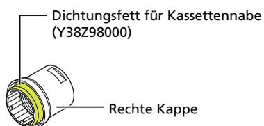
**2. Montieren Sie den Freilaufkörper samt Distanzscheibe und die rechte Kappe.**
