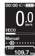
Drücken Sie auf Unterstützung-A oder die Funktionstaste, um die Fahrtdatenanzeige auf dem Display zu [TRIP] zu ändern.
