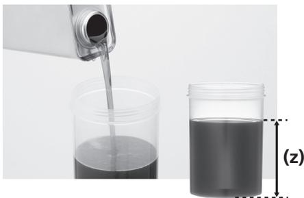
Füllen Sie den Behälter bis zu einer Höhe von 95 mm mit Serviceöl.
