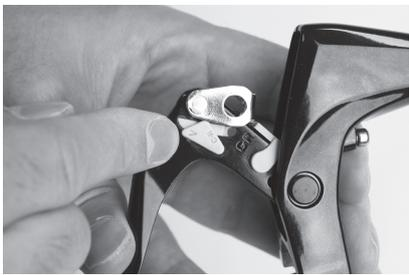
Den Modusschalter auf die Wahlstellung der montierten Bremse ausrichten.
