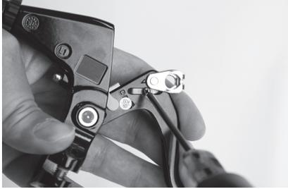
Verwenden Sie zum Lösen der Schraube den Kreuzschraubendreher [Nr. 1].
